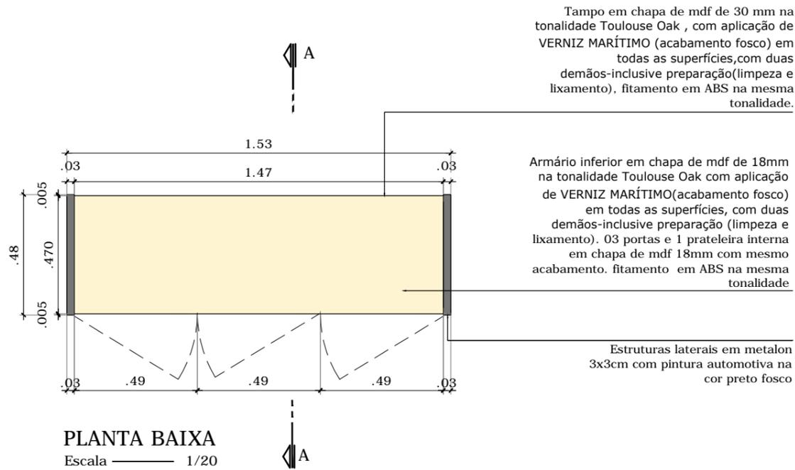
Tampo em chapa de mdf de 30 mm na tonalidade Toulouse Oak , com aplicação de VERNIZ MARÍTIMO (acabamento fosco) em todas as superfícies, com duas demãos-inclusive preparação (limpeza e lixamento), fitamento em ABS na mesma tonalidade.
